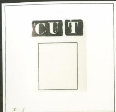
I-3 Defecto de impresión. Manchas blancas alrededor de "CU" y "T" de "cuarto".
